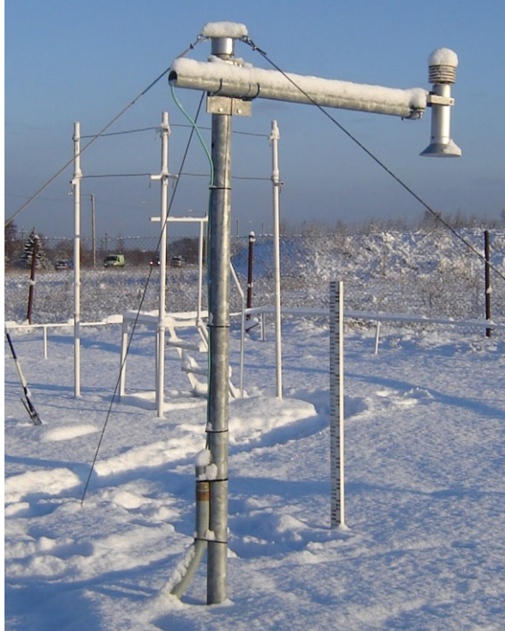
Pilt 4 Lumikatte paksuse sensor USH
