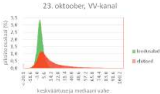
Joonis 2. Loodusalade ja ehitiste keskvärtuse ja mediaani vahed 23. oktoobri Sentinel-1A VV-kanali radaripildil.
