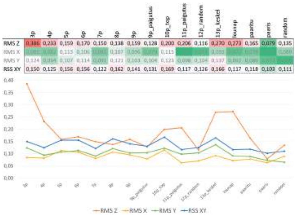
Joonis 5. 3D-mudelite horisontaalne (RSS XY) ja vertikaalne täpsus (RMS Z).
