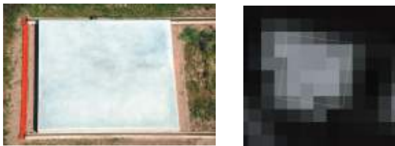
Joonis 5. Foto helikopterilt 27. juulil 2011 (vasakul) ja peegeldusetalon satelliidisensori WorldView-2 punasel spektraalpildil (608 nm) 29. juulil 2013 (paremal). Satelliidipildi piksli suurus on 2 m.
