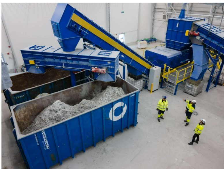
Joonis 7. Kuusakoski mehaaniline komposiitmaterjalide töötlemisliin (allikas: https://www.kuusakoski.com/fi/finland/ajankohtaista/2024/kuusakosken-uutuuslaitos-on-vihrean-siirtyman-puuttuva-palanen3/ ).
