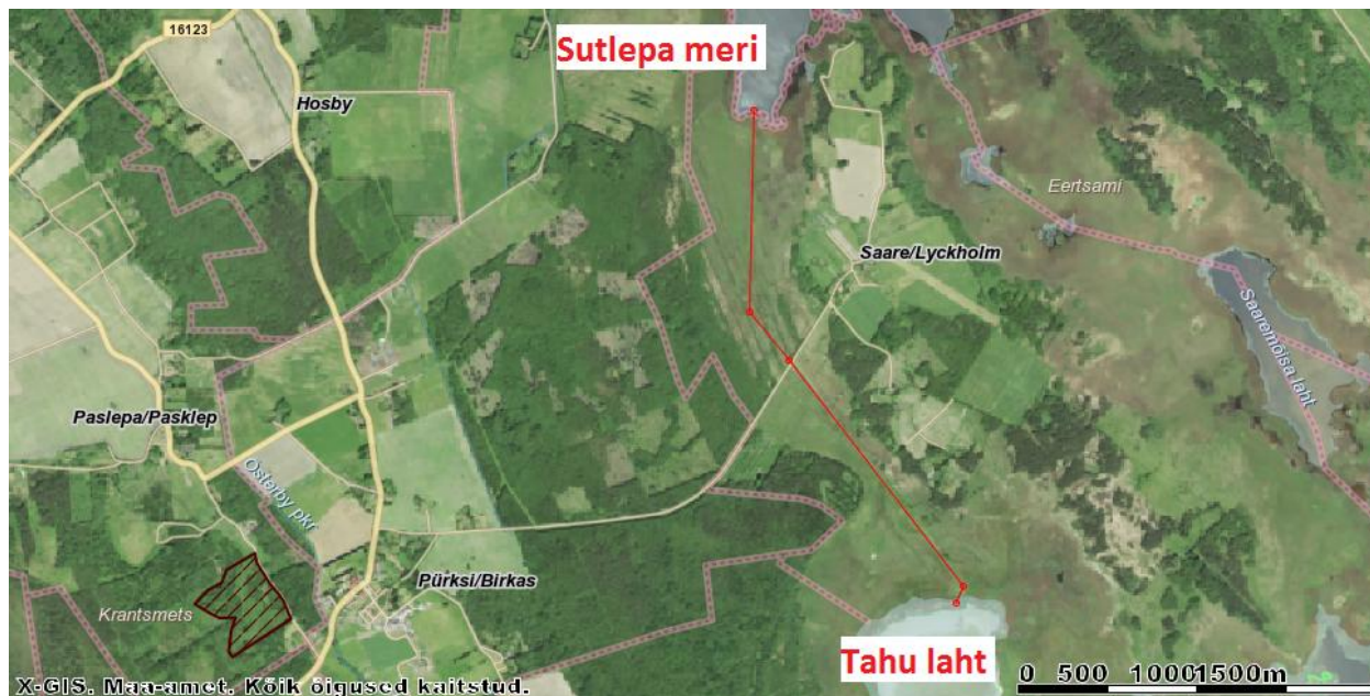
Joonis 2.7. Kanali lõik (punasega) Tahu lahest Sutlepa merre. Joonise mõõtkava 1:30000. Lõigu pikkus on 3,2 km, millest 1,7 km kulgeb Tahu lahes mööda olemasolevat kanalit või kuivenduskraavi.
