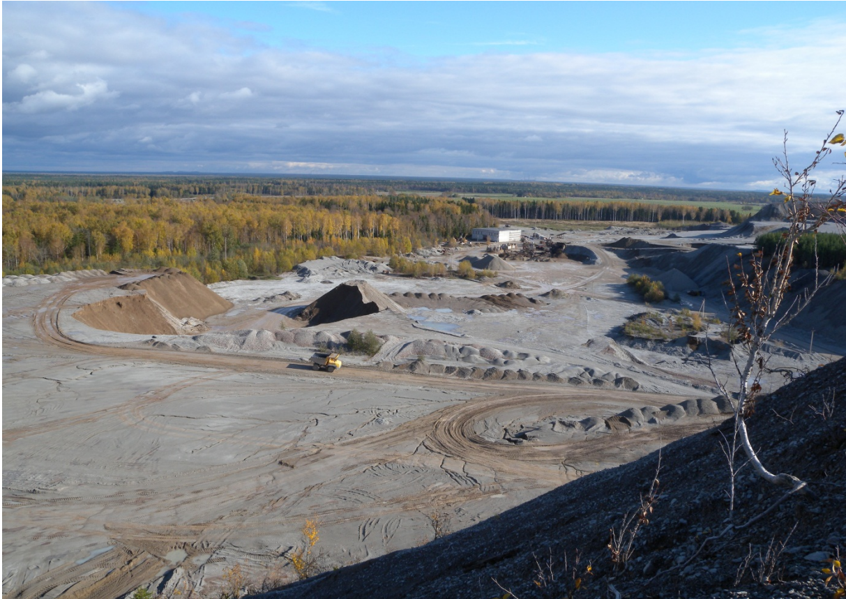
Foto 11 Aheraine sõelumisel allesjääv põlevkivi ladestatakse Ahtmes lamepuistanguna
