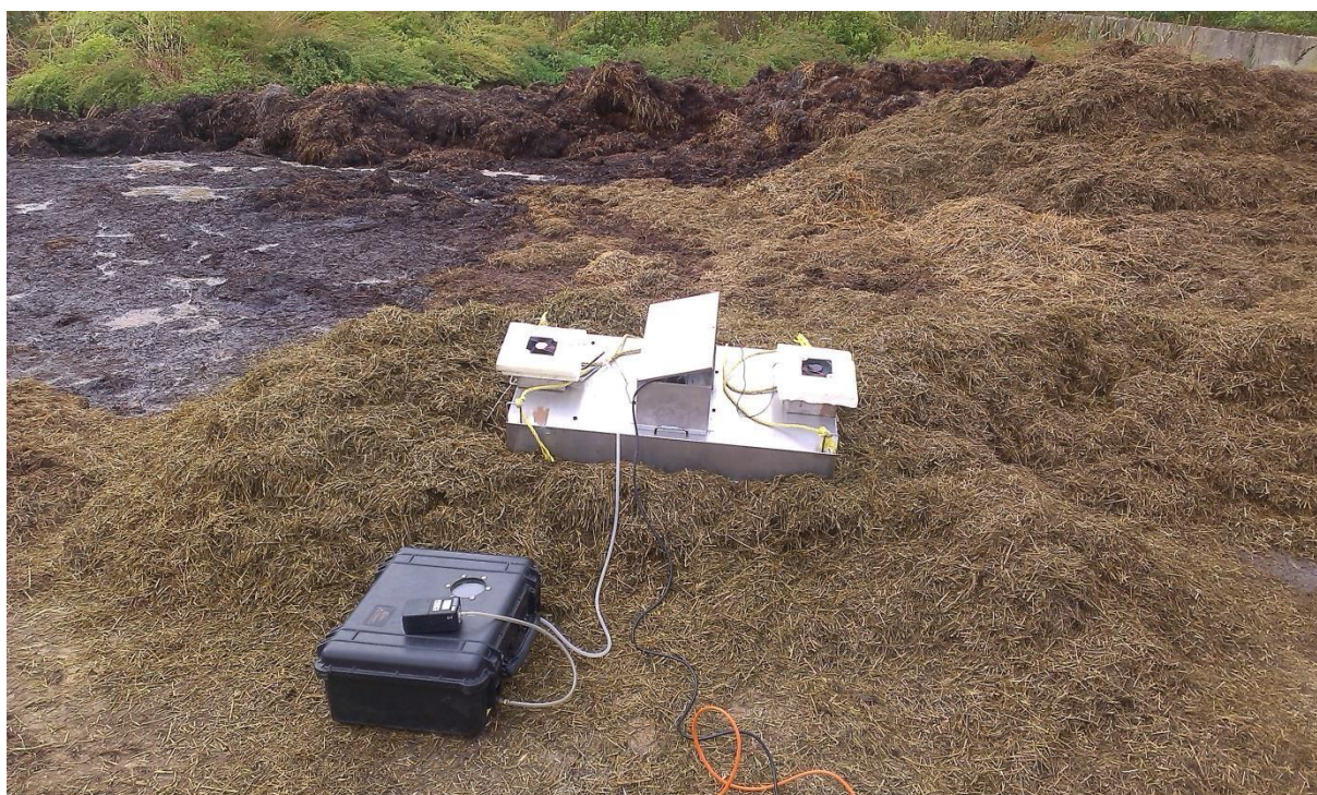
Joonis 5 Lõhnaainete proovivõtt tuuletunneliga hoidla pinnalt
