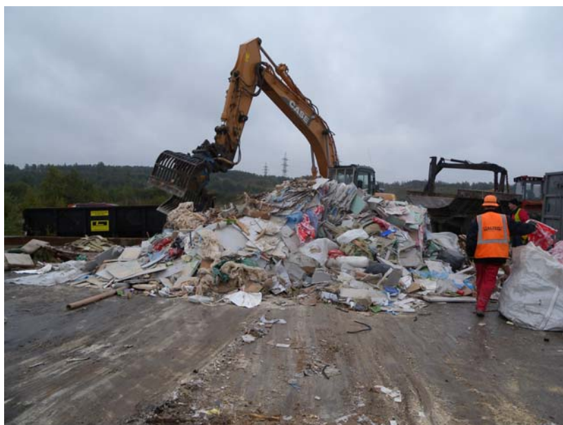
Joonis 11. ATI Grupp OÜ, Vao karjäär, segaprahi mehhaaniline ja käsitsi sortimine
