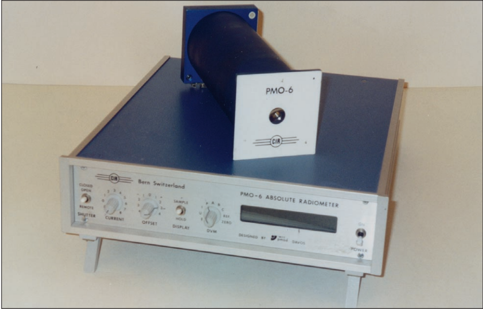
Fig. L.4.2.1-5. Absolute radiometer PMO-6.
