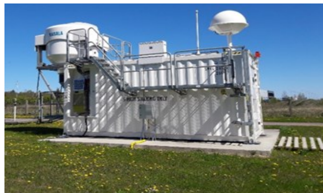
Tallinn-Harku aeroloogiajaama täisautomaatne raadiosondijaam.
