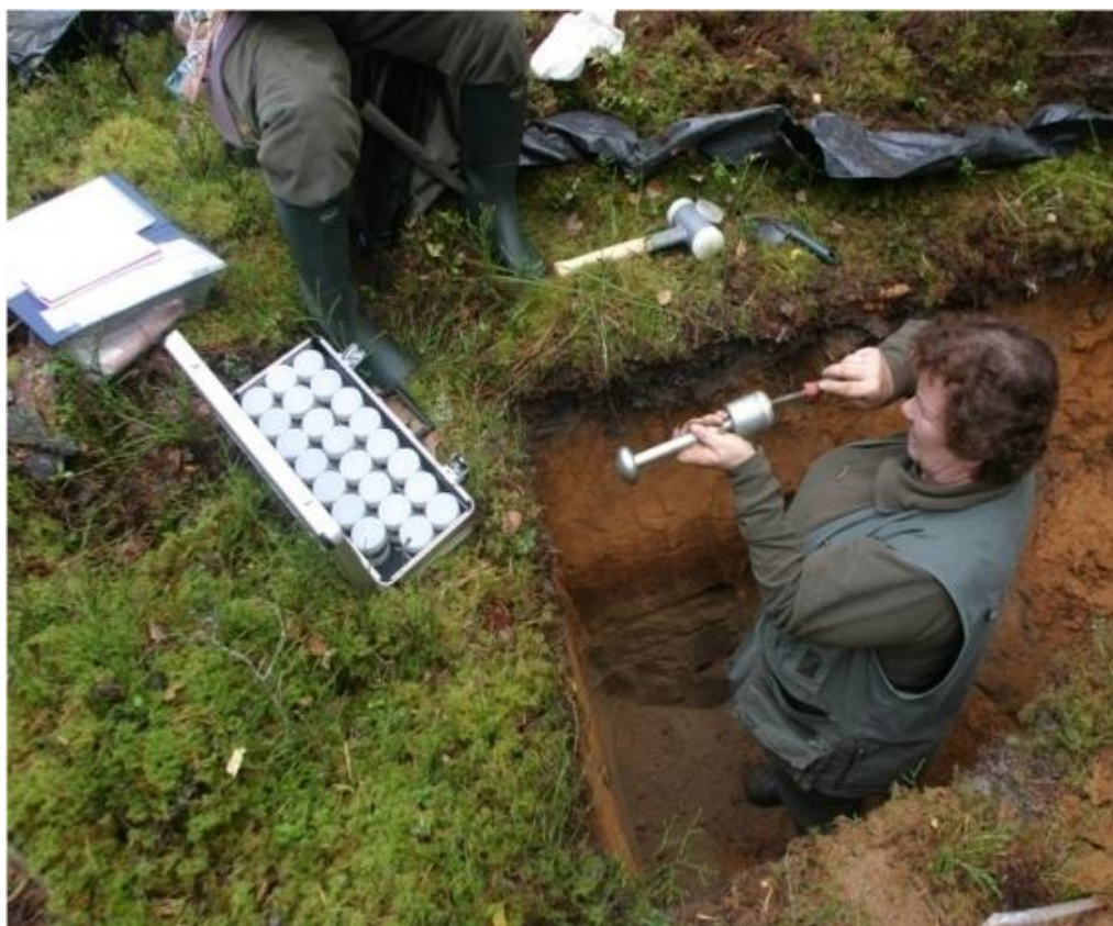
Joonis 5. Lasuvustiheduse proovide võtmine.
