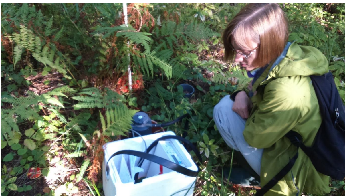
Joonis 10. Mulla CO 2 emissiooni intensiivsuse mõõtmine.
