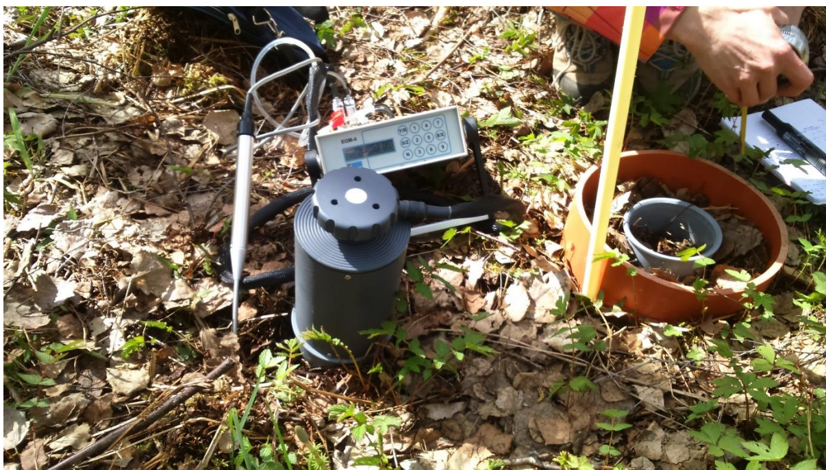
Joonis 9. Varustus mulla CO 2 emissiooni intensiivsuse mõõtmiseks.
